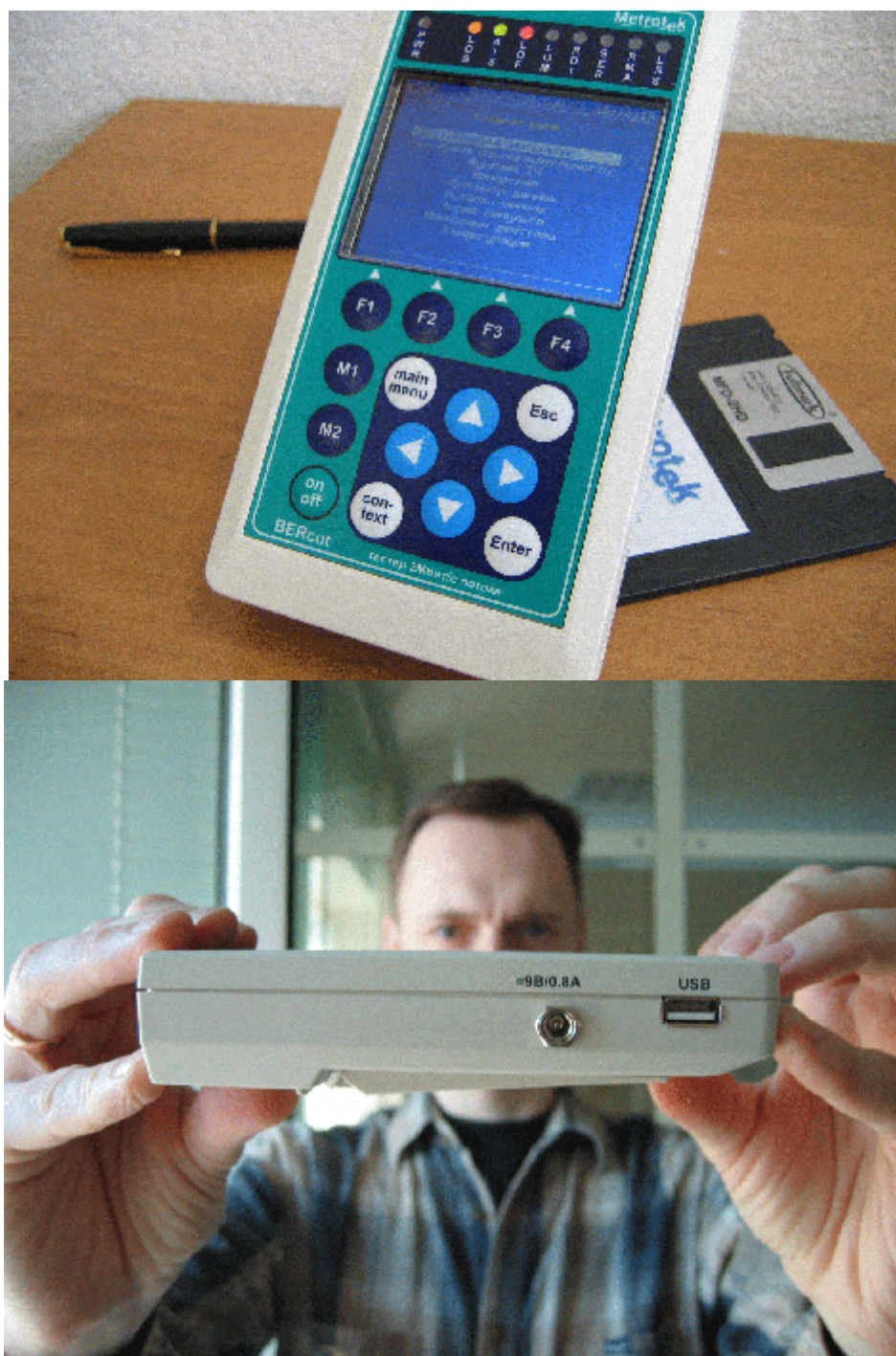
Рис.25. Портативный анализатор ИКМ BERcut обеспечивает уникальные параметры точности измерения джиттера
