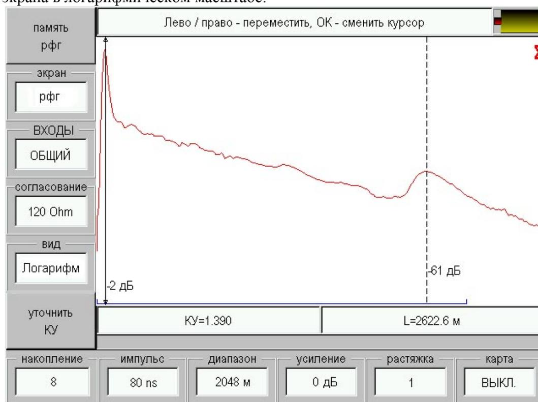
Этот режим отображения используется для быстрого поиска неоднородностей. Полный диапазон просмотра составляет 100 дБ. Верх экрана соответствует 0 дБ, низ - 100 дБ. Кнопка [УСИЛЕНИЕ] не влияет на отображение рефлектограммы. Рядом с курсорами показывается уровень сигнала  $U_{dB}$  в децибелах, относительно уровня зондирующего импульса  $U_0$ :
