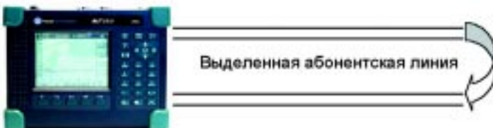
Рис 3. Измерение параметров АЛ по 4-проводному шлейфу
