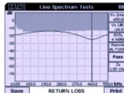
Рис 14. Измерение возвратных потерь в линии
