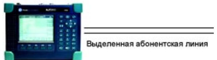
Рис 4. Измерение параметров АЛ по открытой 2-проводной линии
