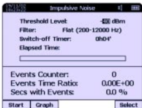
Рис 16. Анализ импульсных шумов
