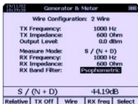
Рис 19. Измерение отношения сигнал/шум
