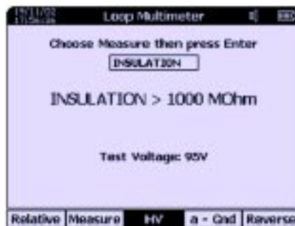
Рис 2. Измерение сопротивления изоляции провода А к Земле
