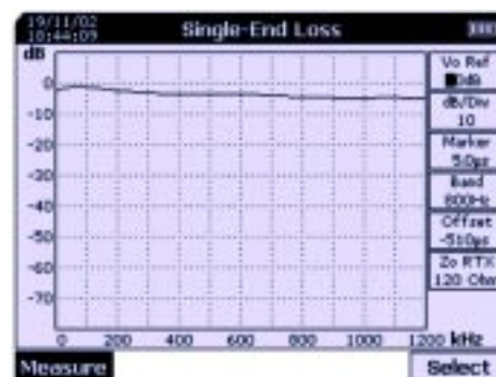
Рис 21. Измерение АЧХ линии с одной стороны
