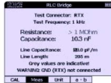
Рис 3. Измерение емкости линии и расчет ее примерной длины
