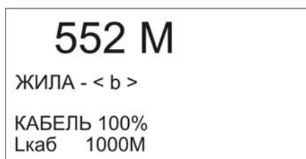
Рисунок 11-5. Экран измерения расстояния до повреждения изоляции
